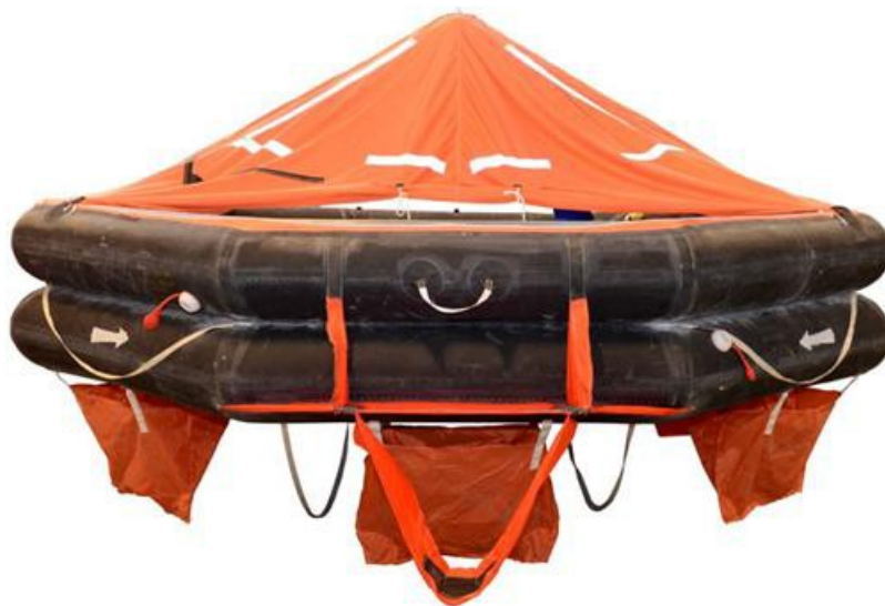
Ilustracja 49. 25-osobowa tratwa ratunkowa Viking typu jak na EL FARO.
