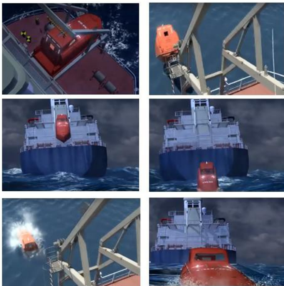
Ilustracja 48. Sekwencja wodowania dla systemu grawitacyjnego, układ łodzi ratunkowej dla swobodnego spadania. Grafika na górze po lewej stronie, załoga wchodzi na łódź i przypina się. Łódź zostaje zwolniona i wpada do wody, a energia kinetyczna odpycha ją od statku. Kiedy łódź wpada do wody, silnik pracuje. (Źródło: Karishma Marine Solutions Pvt Ltd (KARCO), Indie)
