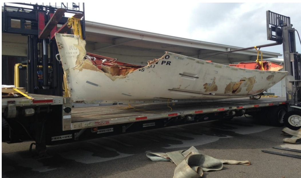
Ilustracja 66. Łódź ratunkowa na sterburcie EL FARO. Widoczne uszkodzenia dziobu na bakburcie łodzi ratunkowej. Fotografia wykonana w Bazie Powietrznej Miami Straży Przybrzeżnej.
